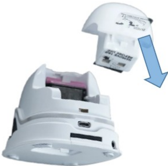
Rys. 10: Folia izolacyjna na styki baterii
